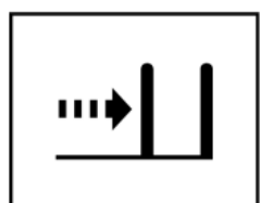
deslocamento lateral do garfo a direita
