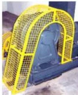
Barreiras de proteção em máquinas e em situações de risco.
